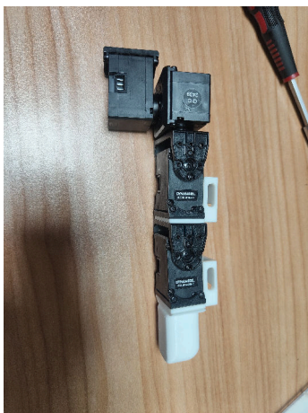
Figura 4.1: Polegar construído de acordo com a Documentação da Leap Hand
