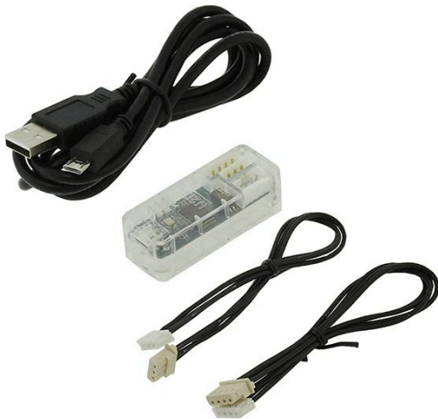
Figura 3.2: Controlador Dynamixel U2D2 utilizado para controlar os motores do projeto
