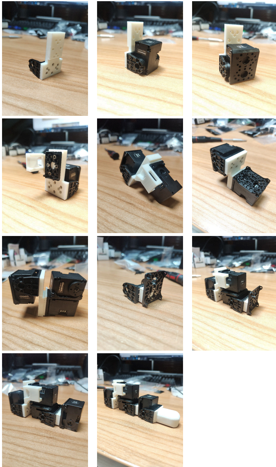
Figura A.2: Fotografias sequenciais da montagem do dedo referente ao dedo indicador, médio ou anelar
